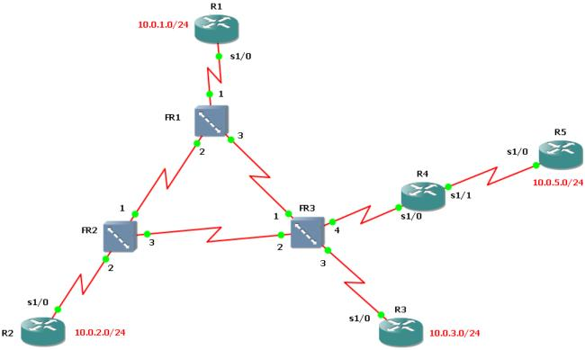
2. Используйте глобальную адресацию Frame Relay: маршрутизатору R1 соответствует DLCI №101, R2 – 102 и так далее. Пример настройки коммутатора FR1 представлен ниже. Коммутаторы настраиваются так, чтобы обеспечить полную связность между маршрутизаторами R1, R2 и R3. Также потребуется дополнительная связь между маршрутизаторами R3 и R5. Маршрутизатор R4 будет выполнять функции FR-коммутатора (пока никак не настраивается).
